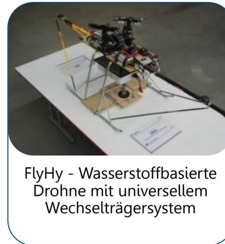
FlyHy - Wasserstoffbasierte Drohne mit universellem Wechselträgersystem
