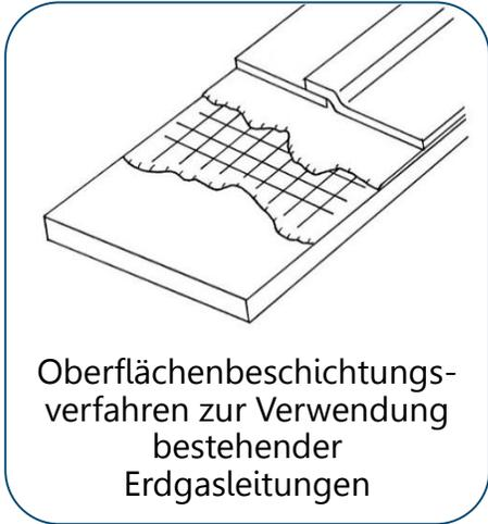
Oberflächenbeschichtungsverfahren zur Verwendung bestehender Erdgasleitungen
